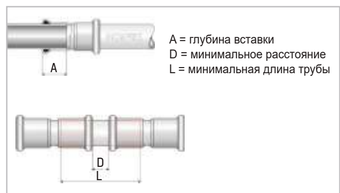
Рис. 27. Глубина вставки и минимальные размеры.
